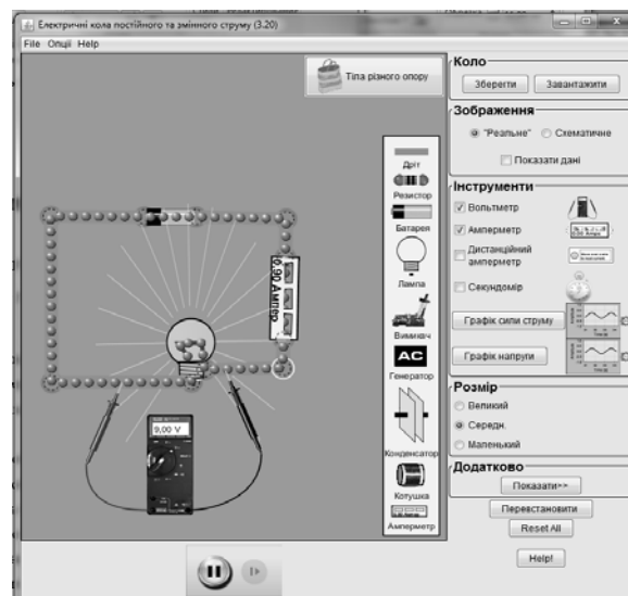
Рис. 2.14. Електричне коло з послідовним з'єднанням (відповідно до схеми на рис.2.12) 2
