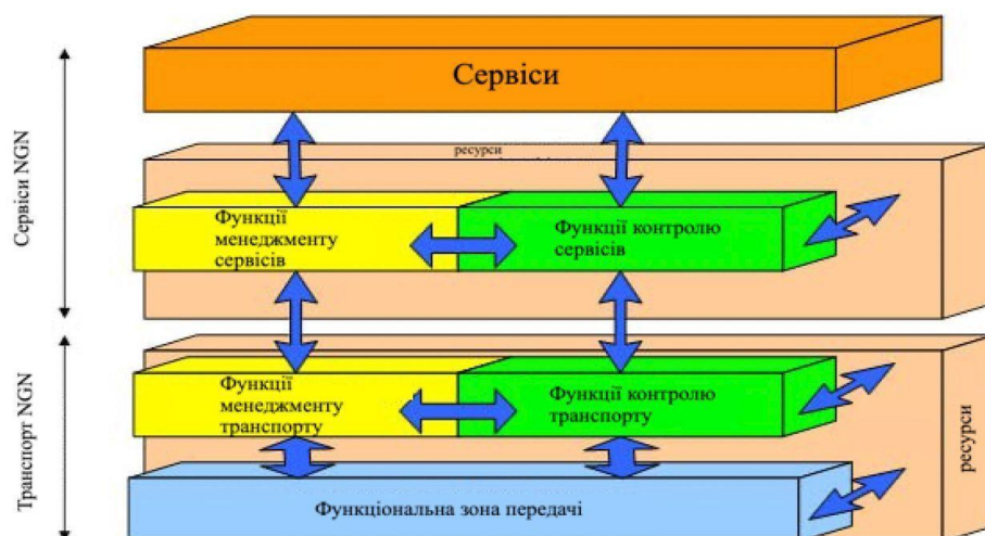
Рисунок 7.3 - Узагальнена функціональна модель мультисервісних вузлів
