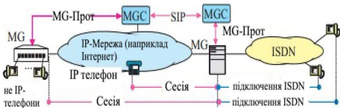
Рисунок 9.3 - Важливість протоколів MG при інтеграції IP-мережі з ISDN.
