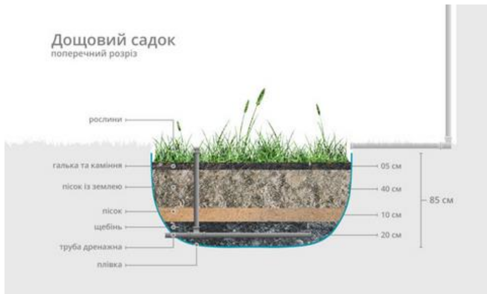
Рис. 3.6 Поперечний розріз дощового садка (ілюстрація громадського об'єднання «Плато») 81
