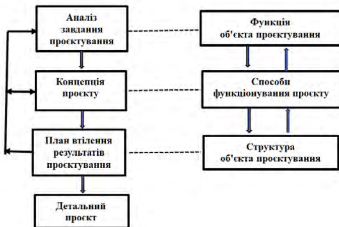
Рис. 2.2. Зв'язок між функцією, способом функціонування та структурою об'єкта в процесі його проектування (адаптовано з (Gero & Kannengiesser, 2004))
