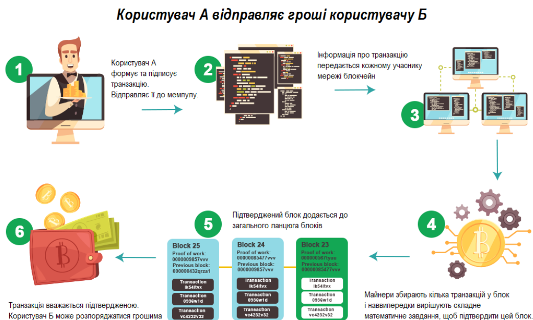
Рис. 1.17. Спрощена схема роботи Blockchain
