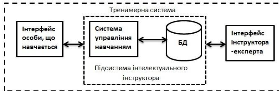
Рисунок 1 – Схема комп'ютерного тренажера з автоматизованою функцією інструктора
