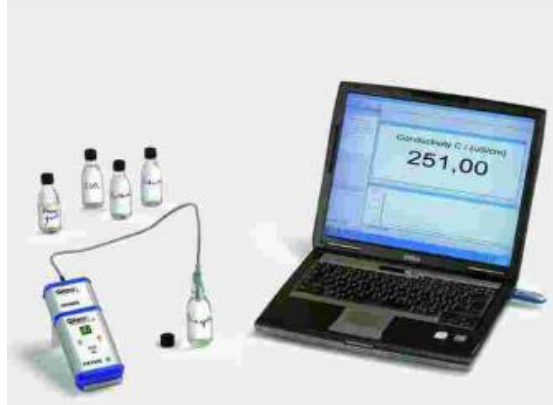
Рис. 4. Дослідження провідності різних зразків води.
