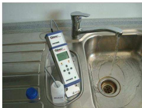
Рис. 5. Вимірювання значень провідності зразків питної води в домашніх умовах.
