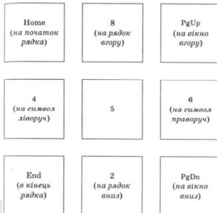
Рис. 1.22. Призначення клавіш цифрової клавіатури за вимкненого режиму NumLock
