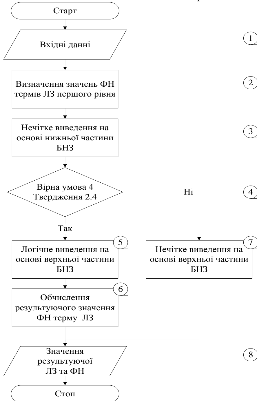
Рис. 5.9. Алгоритм обробки інформації на основі деревоподібних БНЗ зі змішаною схемою виведення
