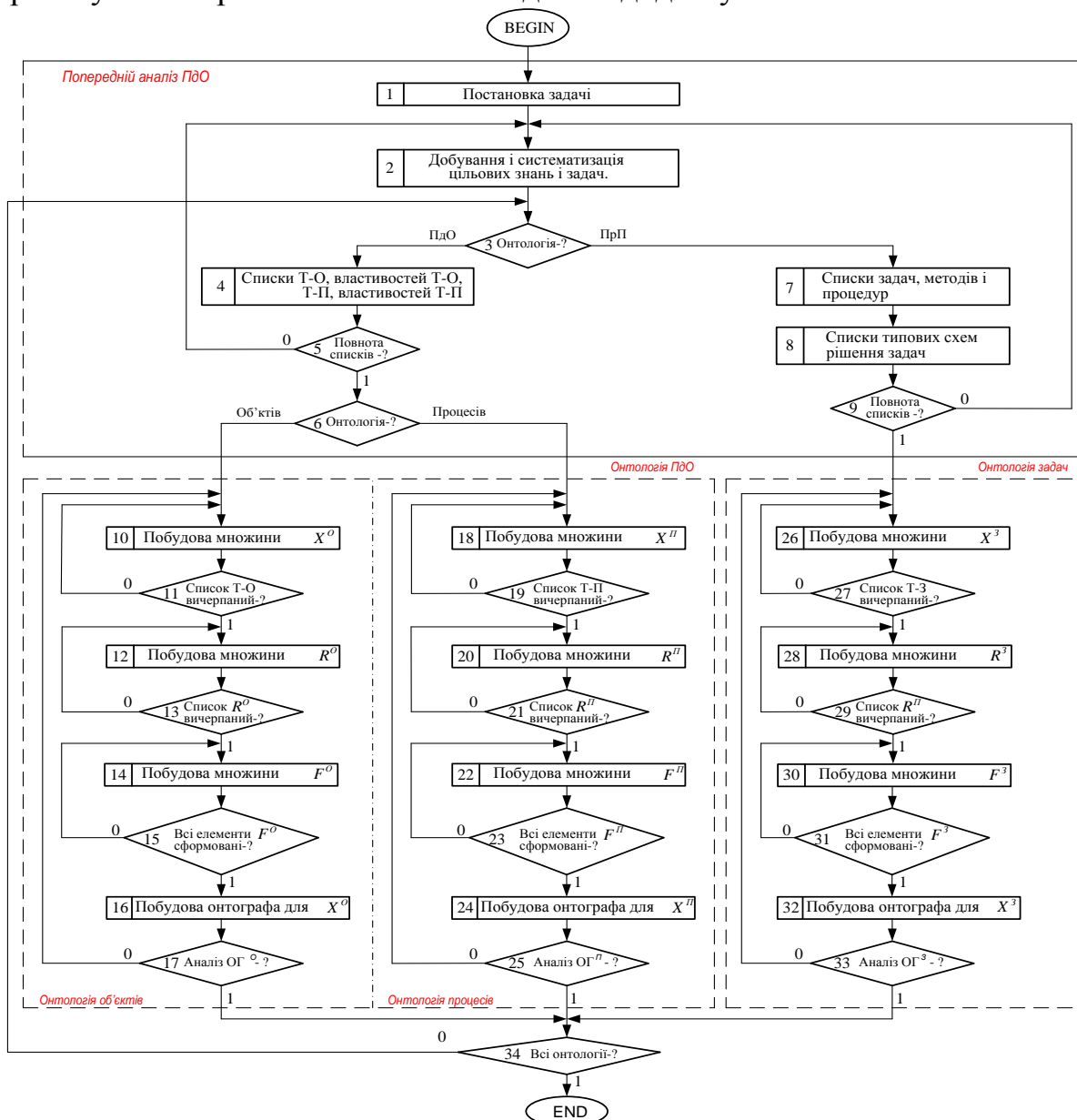
Рис. 2.15. Блок-схема алгоритму проектування онтології ПдО та онтології задач
