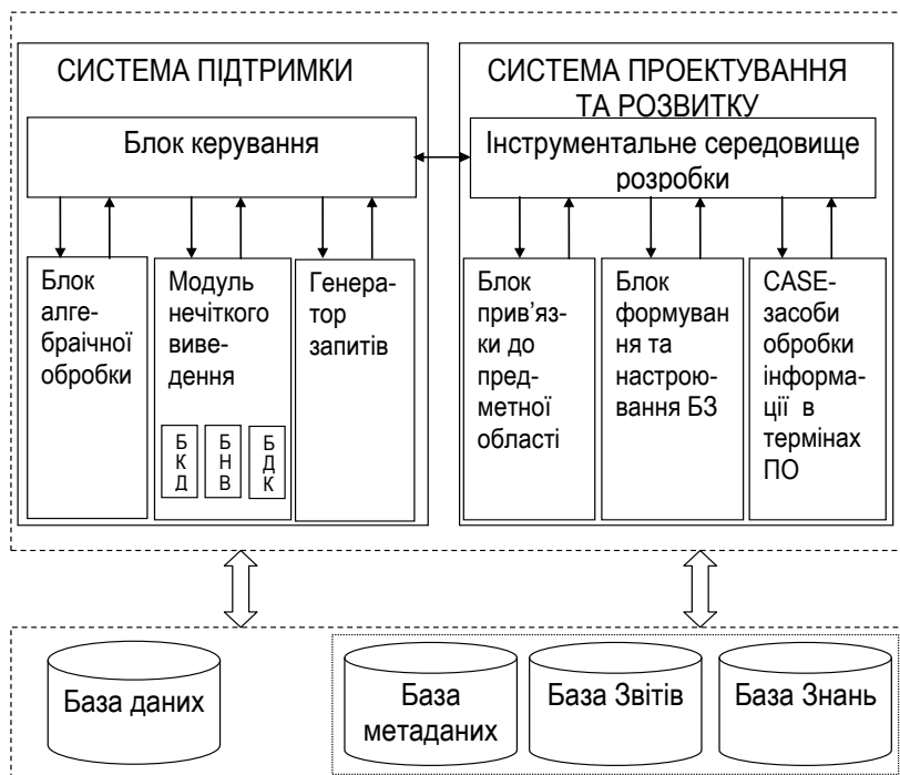
Рис. 7.1. Структурна схема інструментальних засобів гнучкої технології створення ПМОІ
