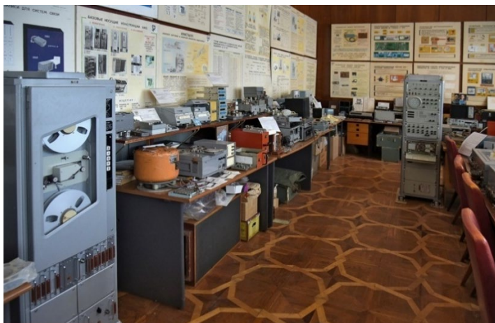
Рис. 2. Зал спеціальної техніки. На першому плані магнітофон УРВ-1 («Корунд-1»), на столі-реєстратор «Марс-Б» (померанчевий) для авіаційних апаратів типу «чорна скриня»
