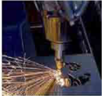
Мал.15. Лазерна обробка металу: а – схема; б – процес обробки
