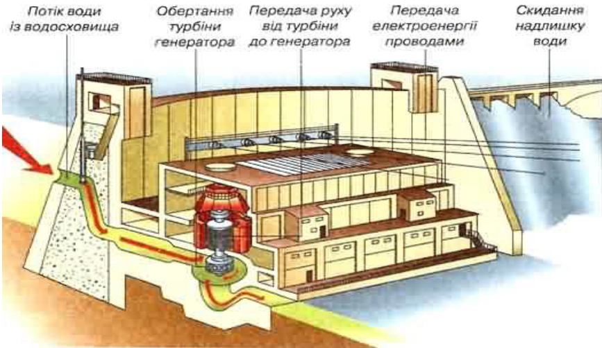
Мал.12. Перетворення енергії падаючої води в електричну енергію на гідроелектростанції
