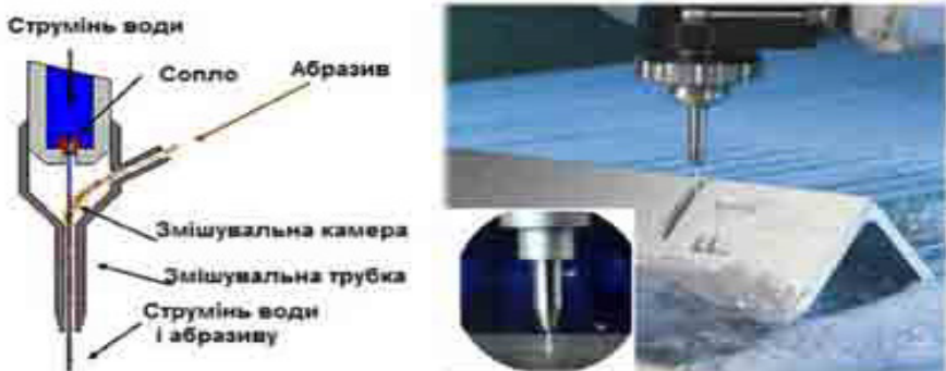
Мал. 16. Гідроабразивна обробка: а — схема; б — процес обробки
