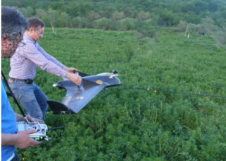
Малюнок 4. Запуск фіксованого крила RF-18 з гумової катапульти.
