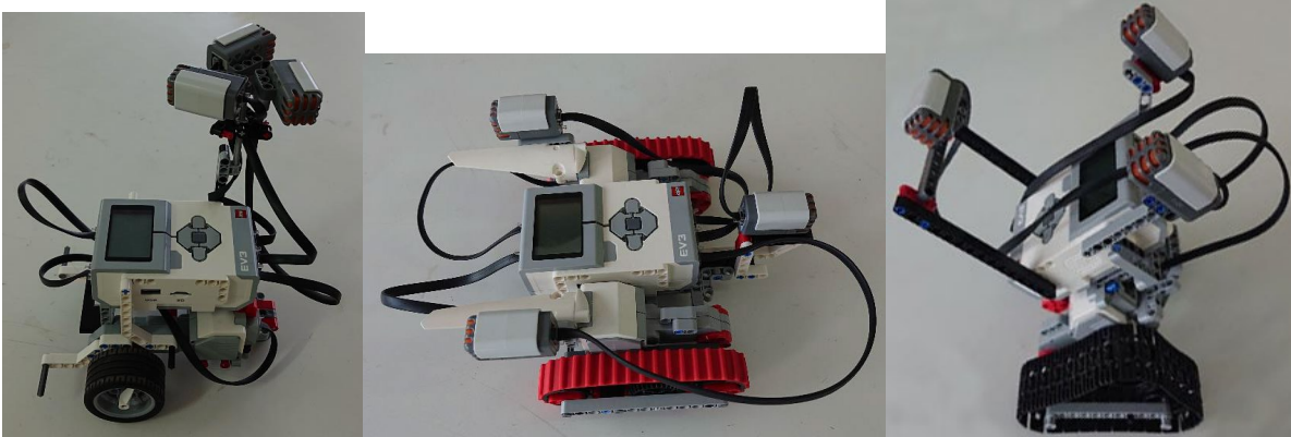
Рис. 6. Роботи, що здійснюють триангуляцію джерела звуку і рухаються в напрямку звуку
