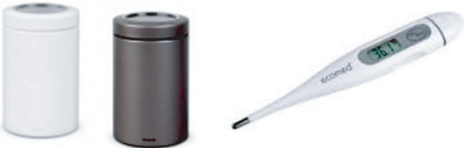
Рис. 10.6. Однакову кількість гарячої води з-під крана наливають у контейнери та вимірюють температуру
