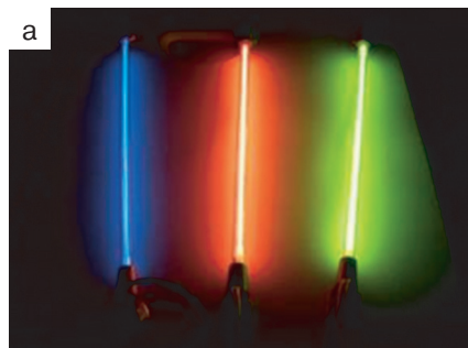
Рис. 35.5. Механізм йонізації електронним ударом
