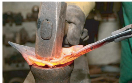
Рис. 2.2. Щоб змінити форму залізної деталі, її попередньо сильно нагрівають та докладають значні зусилля
