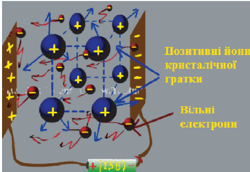
Рис. 27.2. Рух вільних електронів у провіднику сповільнюється внаслідок їх взаємодії з йонами кристалічних ґраток
